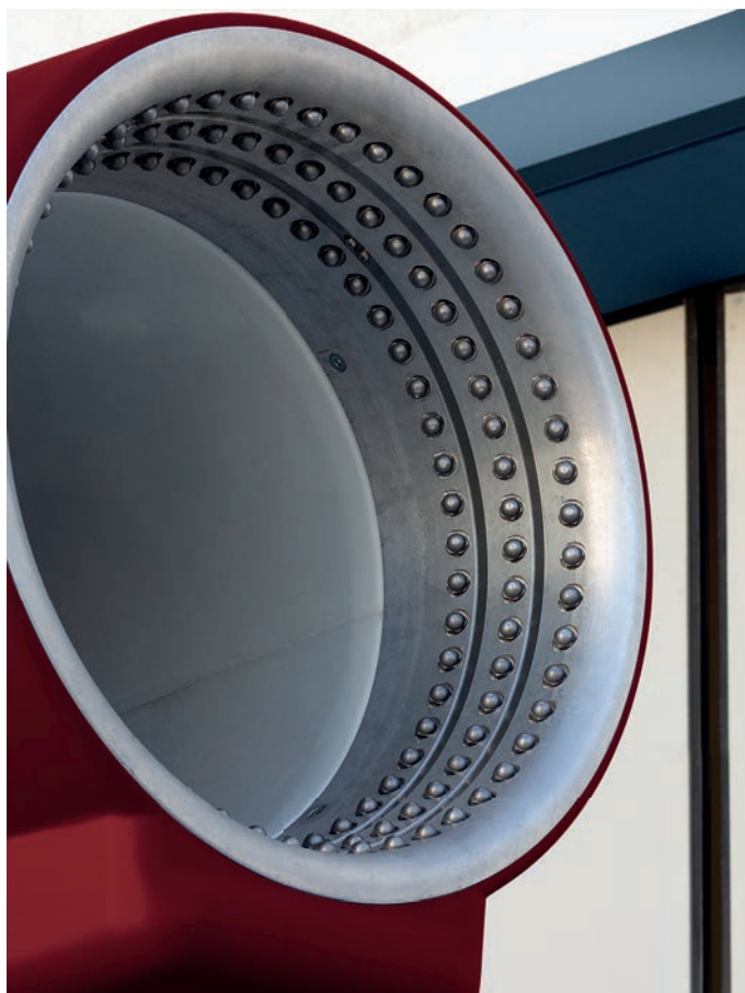
Corona da 156 ugelli con resistenza riscaldante
