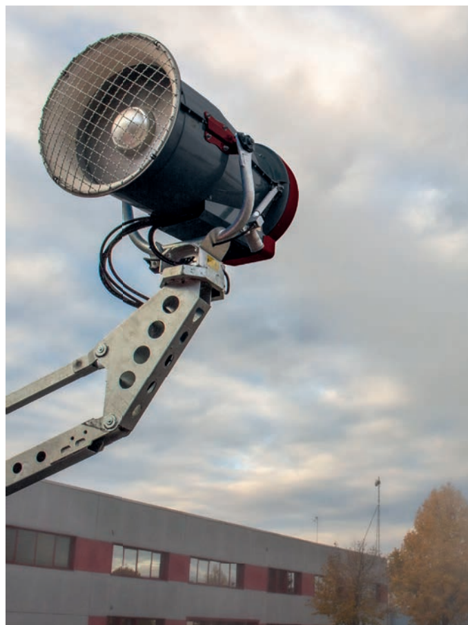
Braccio idraulico telescopico, altezza massima fino a 5 metri
