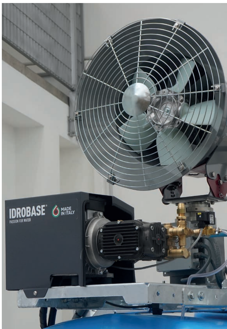
Dettaglio modulo con pompa 3 pistoni ceramica
