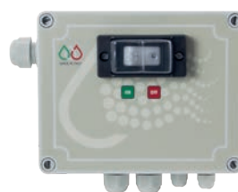
Quadro elettrico Fog 60, completo di interruttore termico 7A, 3m cavo elettrico, cavo per elettrovalvole ingresso e scarico 230V Connettore pressostato e connettore per comando remoto.
