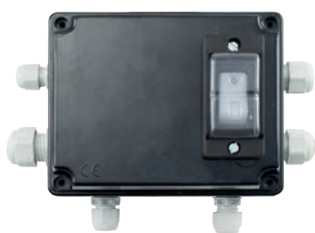
Quadro elettrico monofase 230V-50Hz, completo di: cavo di alimentazione 3m, interruttore 7A e cavo alimentazione elettrovalvola
