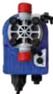
**Pompa dosatrice elettromagnetica con microprocessore: portata max 2l/h,** pressione max esercizio 7bar, regolazione manuale di portata da 0 (stop operazioni) al 100% della portata massima, alimentazione standard 100 - 240VAC 50/60Hz, rivestimento plastico esterno in PP, grado di protezione IP 55, testata pompa con valvola di adescamento manuale, predisposizione per collegamento sonda di livello (mancanza prodotto)
