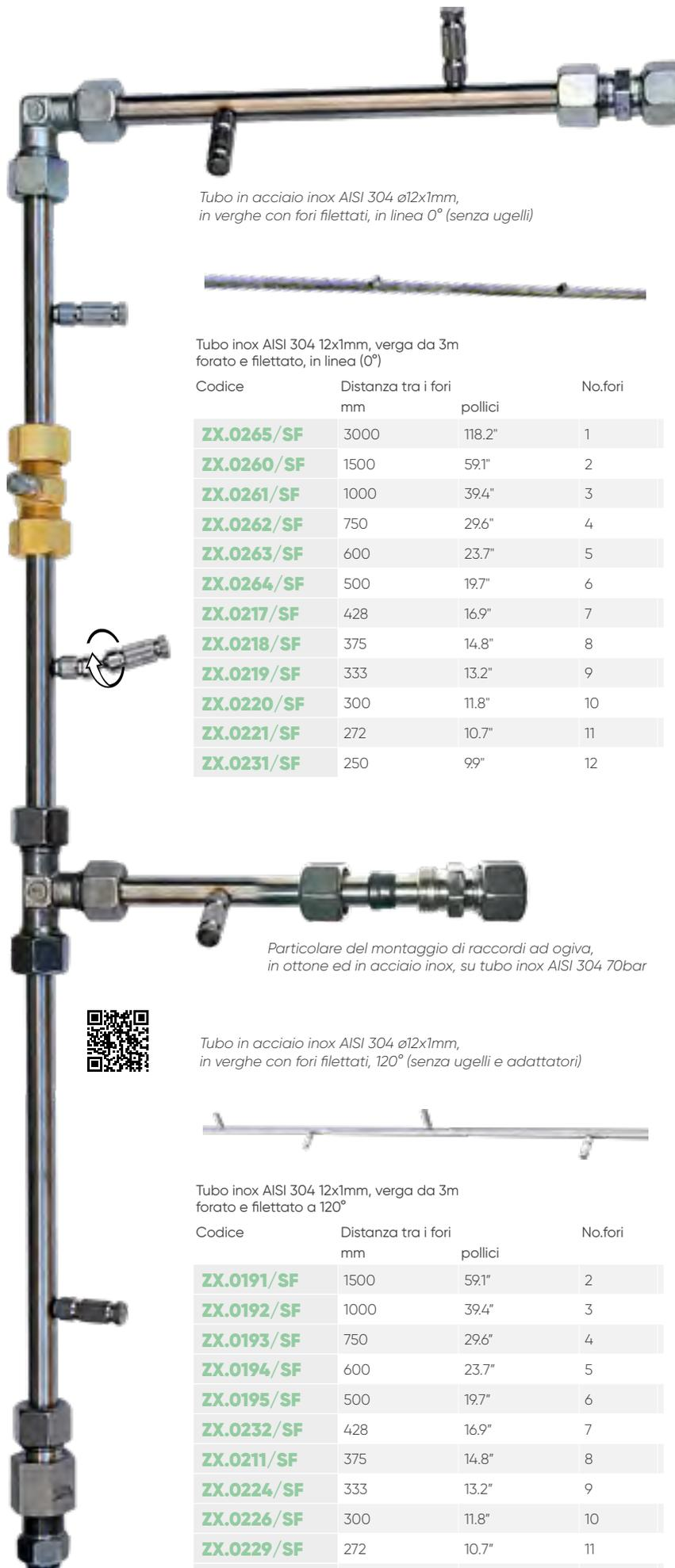
*Tubo in acciaio inox AISI 304 ø12x1mm, in verghe con fori filettati, in linea 0° (senza ugelli)*
