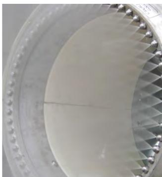
Particolare della bocca del Fog Maker ATEX con evidenziata la corona di 60 ugelli nebulizzanti in azione
