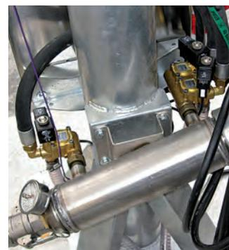
Particolare del sistema di filtraggio in rete in acciaio Inox AISI 303
