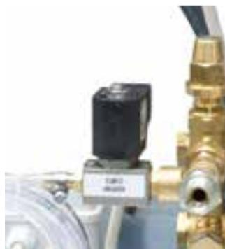
Particolare dell'elettrovalvola di scarico e della valvola di by-pass
