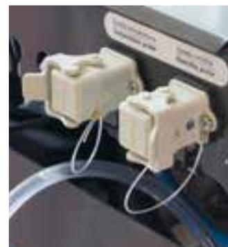
Conessioni elettriche per le sonde di umidità ZX.SU20 e temperatura ZX.ST20
